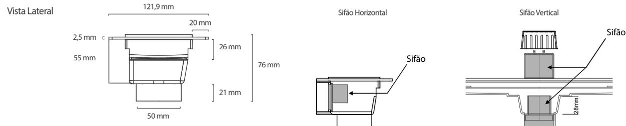
Materiais: tampa de aço inox 304. Base: PVC. Caixa sifonada: acoplável em caixas sifonadas de 100 mm e de 150 mm. Subtampa: aço inox 304. Essa peça funciona como berço para acomodar uma tira de piso colado como acabamento final. Grade retentora, ventosa e Fecha Ralo (exceto nos modelos sifonados) acompanham o produto. Produto patenteado.
