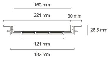
Materiais: Base em PVC. Subtampa: PVC. Essa peça funciona como berço para acomodar uma tira de piso conforme paginação do ambiente, colado como acabamento final. Produto patenteado.
