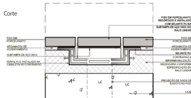
Materiais: bases: PVC (modelo 130) e aço inox 304 (modelos 120 e 160).
