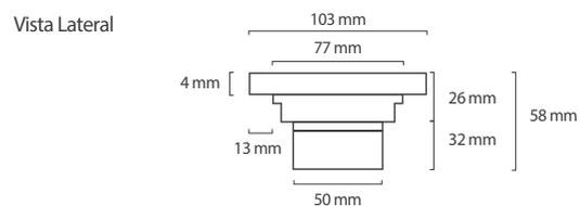
Materiais: tampa: aço inox 304. Base: ABS. Caixa sifonada: acoplável em caixas sifonadas de 100 mm e de 150 mm. Subtampa: aço inox 304. Essa peça funciona como berço para acomodar uma tira de piso colado como acabamento final. Grade retentora, ventosa e Fecha Ralo acompanham o produto. Bolsa acoplável e bucha de redução vendidas separadamente. Produto patenteado.
