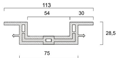
Material: Base em PVC e tampa em aço inox 304, com corte a laser. Produto patenteado.
